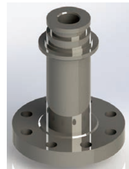
高温型阀盖 温度：232℃ 以上， -100℃ ~ -18℃ 该阀盖可高效散热， 防止工况高温流体的热 传入填料和执行器。
